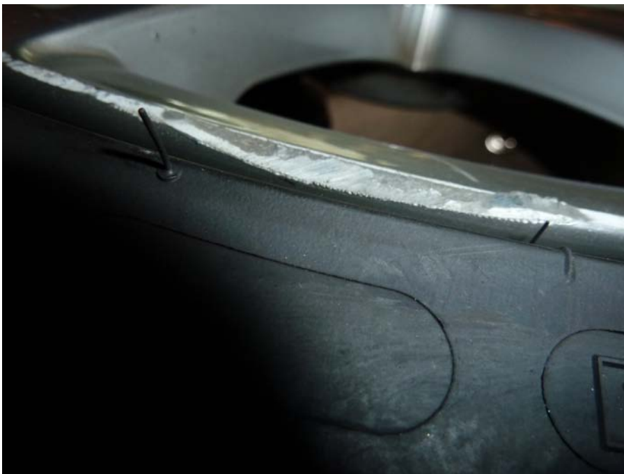
Fehlendes Material / Anstoß
