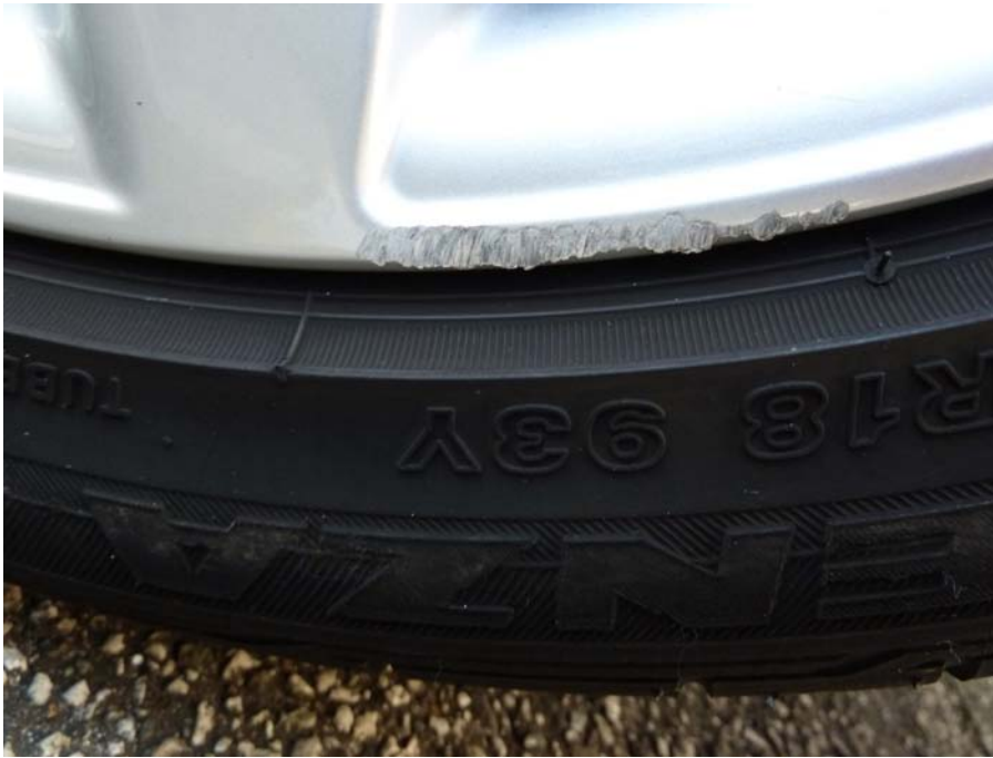
Starke Oberflächenschäden mit Materialverschiebung
