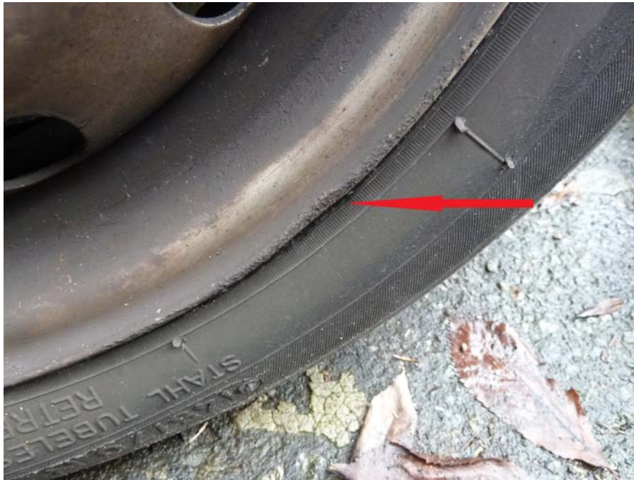
Leichte Verformung am Felgenhorn und leichter Abrieb
