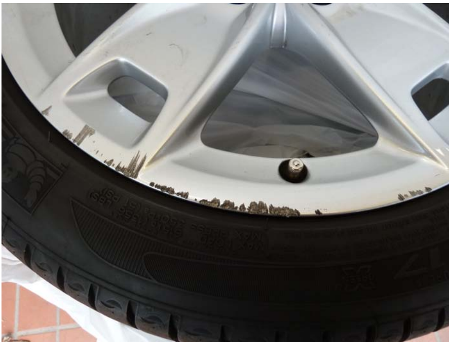
Starke Oberflächenschäden mit Materialverschiebung
