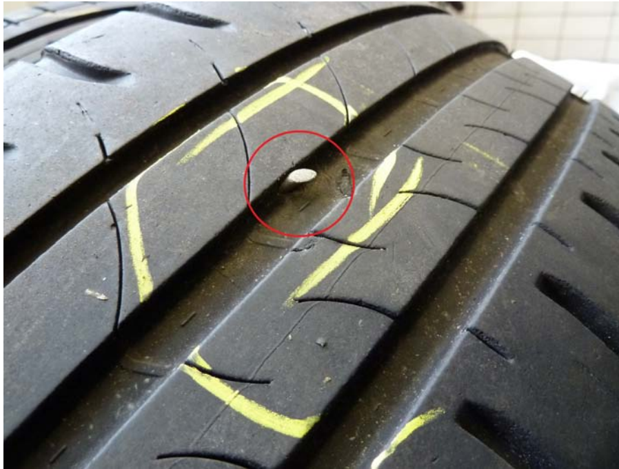
Fremdkörper in der Lauffläche
