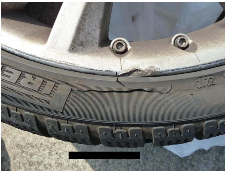
Schnitt in der Flanke, tiefer als 1mm
