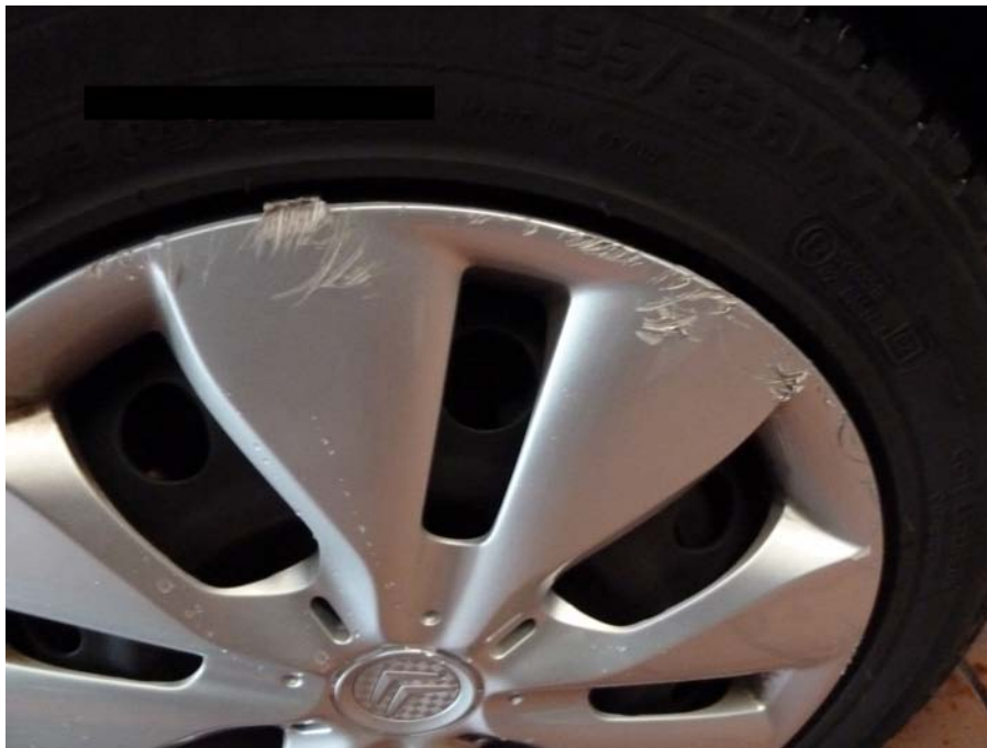
Starke Oberflächenschäden mit Materialverschiebung
