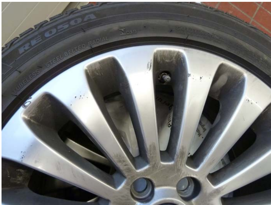
Leichte Oberflächenschäden in der Fläche
