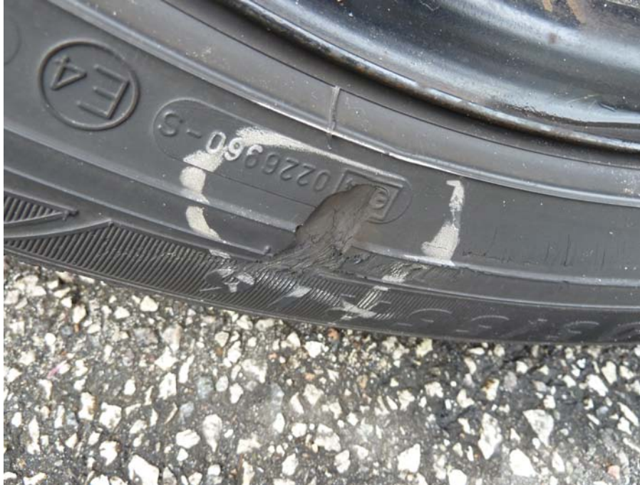
Materialausbruch in der Flanke, tiefer als 1mm
